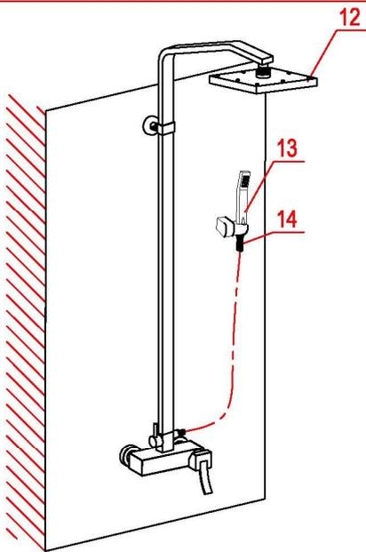
7. Installieren Sie Regenbrause (12). Nach Anschluss eines separaten flexiblen Schlauches (14) zum 3-Wege-Ventil der Brause (13) hängen Sie die manuelle Brause auf den Haken ab. Damit ist die Montage beendet.
